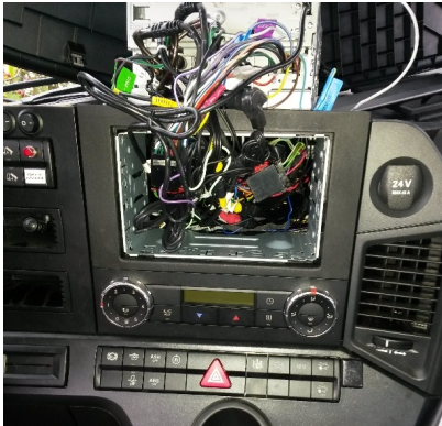
Zündung für das Radio: verbinden mit Interface (Kabelfarbe: rot) Ignition for stereo: connect to the Interface (color of wire: red)
